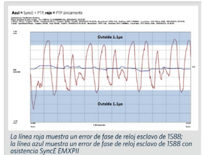
Fig. 4. Error de reloj esclavo para 1588v2 con asistencia SyncE y sin ella.
